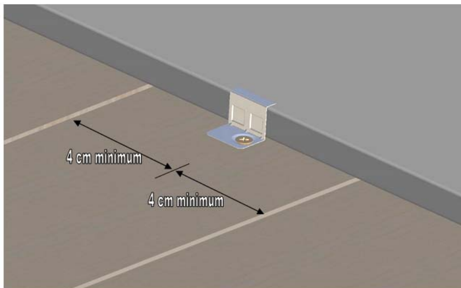
Figure 5 bis – Positionnement de la vis avec la patte fixe
